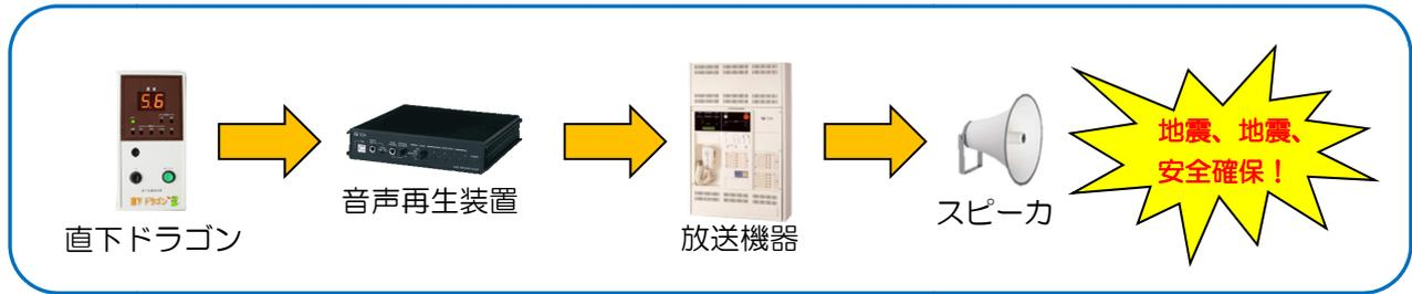
■緊急地震速報受信機と連動：緊急地震速報を併用すれば、より確実に地震を警告！
